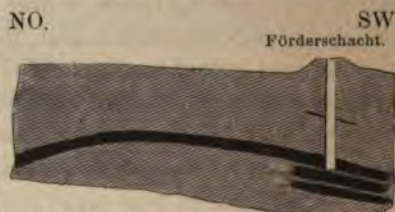
Profil durch den Förderschacht der Grube Phönix.
